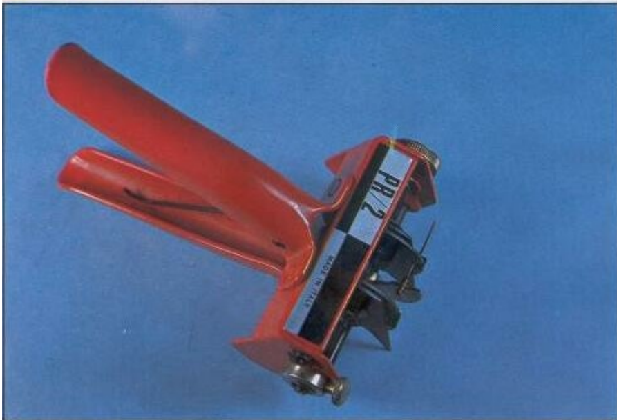
Conformador de componentes axiales. Se puede observar el doblado de terminales de una resistencia
