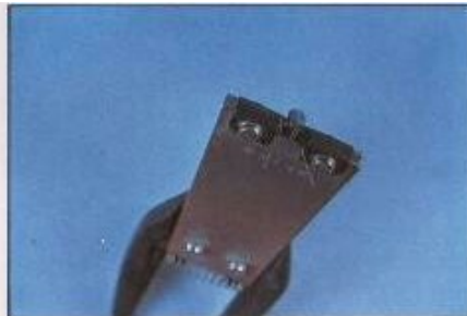
CONFORMADOR DE COMPONENTES RADIALES. En primer plano puede observarse un condensador cerámico ya conformado.
