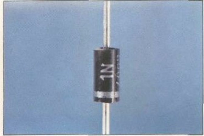
17. Después de realizar la soldadura y el corte de los terminales de los condensadores, en la misma forma que se hizo para las resistencias, se procede a montar el conjunto de semiconductores. En la foto se observa el diodo rectificador 1N4007 que ha colocado en la posición D1.
