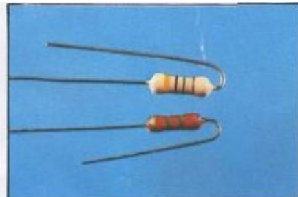
9. Dos resistencias, con sus terminales ya preformados, dispuestas para el montaje. No es necesario, en este caso, tener en cuenta ninguna precaución relacionada con la polaridad. pudiéndose doblar cualquiera de ellos.
