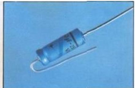
10. Condensador electrolítico C4 indicando la forma correcta en que debe de ser preformado . Se puede observar que se ha doblado el terminal correspondiente al signo +.
